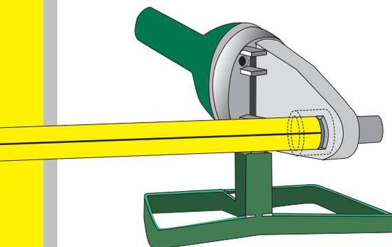
La fusión se realiza por contacto directo de las superficies a unir, que deben encontrarse en estado plastificado. Al terminar el proceso de fusión molecular se podrá observar en la unión un cordón visible formado por el propio arrastre del material plastificado. La temperatura en las boquillas puede oscilar entre 245°C y 275°C.
