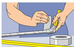
**4.** Uniones: Extender la cinta de los tubos hasta cubrir completamente la protección de los accesorios ya encintados.
