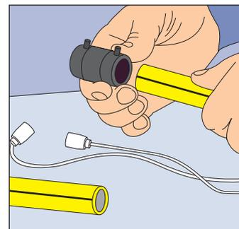
**4.** Una vez introducidos los caños hasta la marca, conectar los bornes de la cupla eléctrica al electrofusor y seguir las instrucciones del equipo en uso.
