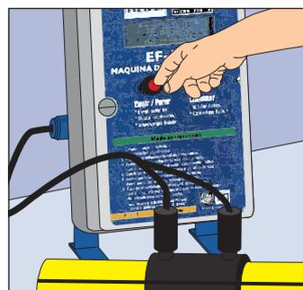
**5.** Durante la electrofusión y la consiguiente etapa de enfriamiento, evitar movimientos y tracciones sobre el ensamble por espacio de 10 minutos.
