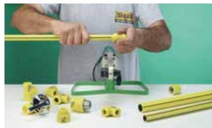
3. Unión por Thermofusión
