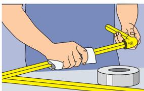
**1.** Preparación: Asegurarse de que la tubería esté limpia y seca antes de aplicar la cinta. Usar únicamente cinta de aluminio Sigas Thermofusion®.
