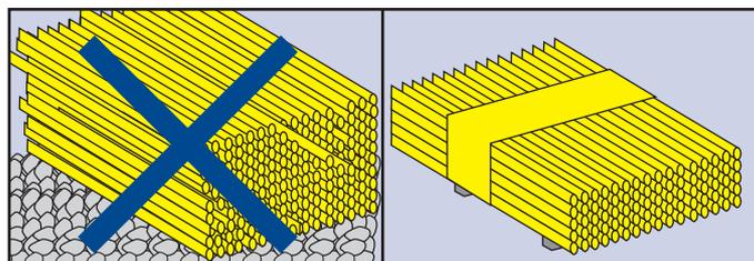
6. El estibado de los tubos se realizará siempre sobre superficies planas y limpias. Cuando el piso sea irregular o abrasivo, la estiba estará sobre armazones de madera o tirantes de material adecuado.
