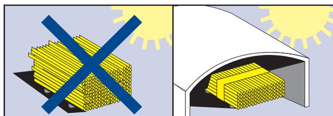
4. Las tuberías deberán almacenarse bajo cubierta, protegidas de la acción solar.
