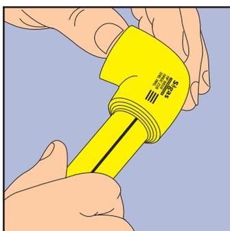
**10.** Frenar la introducción del tubo cuando se juntan los dos anillos que se forman con el corrimiento del polietileno. Dejar reposar cada thermofusión® hasta que se enfríe totalmente (ver tabla I de pág.12).
