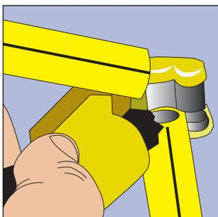
**1.** Para asegurar una correcta electrofusión, cortar el tubo con un cortatubo en un ángulo de 90°.
