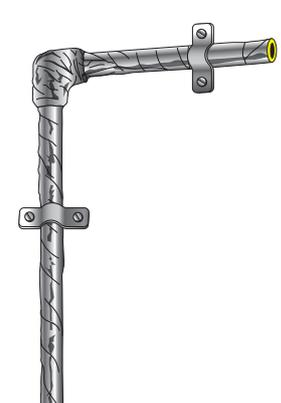
**5.** Refuerzo en grampas: En los puntos con grampas metálicas, aplicar dos vueltas adicionales de cinta en sentido perpendicular al eje de la tubería para reforzar la protección. En tuberías a la vista en vertical se deberá dejar descubierta la cinta de aluminio hasta 2,5 mts del piso.
