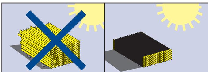
5. Los tubos en obra se podrán estibar algún tiempo a la intemperie, protegidos con una cubierta de polietileno negro, y de modo tal que quede una cámara de aire entre la lámina y los tubos.
