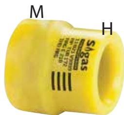
**BUJES DE REDUCCIÓN:** Son del tipo **Macho-Hembra (MH)** con un enchufe en uno de sus dos extremos para recibir el tubo de diámetro menor. En cambio, el otro extremo del buje, el macho, se termofusionará al enchufe del accesorio cuyo diámetro se busca reducir.
