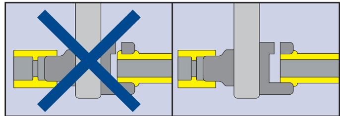
**6.** En la termofusión de tubos de 20 y 25mm no superar el borde exterior de la boquilla ranurada. En diámetros de 32mm en adelante debe respetarse la profundidad de inserción de los tubos que se indican en la tabla 2 de la pág. 12. No pretender verificar el diámetro exterior de los tubos usando como contralor las mismas boquillas en frío.
