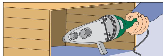
**8.** En zonas de muy bajas temperaturas o expuestas a fuertes vientos, proteja el termofusor en recipientes aislados, para mantener su temperatura de trabajo en condiciones estables.
