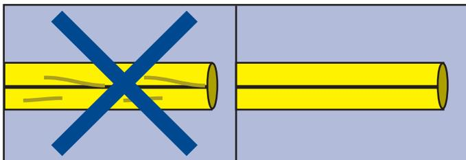
1. Si los tubos evidenciaran un marcado deterioro que hiciera inviable su instalación o reparación con los medios previstos, deberán desecharse.
