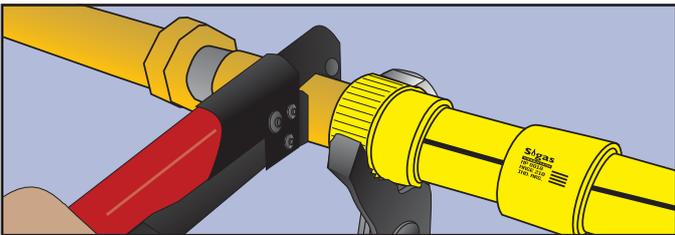
**3.** Al unir dos piezas roscadas se deben emplear dos llaves de fuerza. Con una, se realiza el enroscado y con la otra se sujeta la pieza vinculada con extremos rosca-fusión, para evitar la rotura de la unión fusionada.
