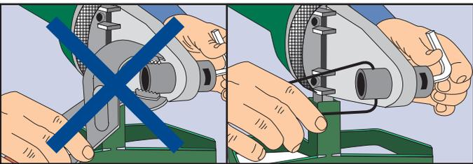
**5.** Para cambiar las boquillas en frío o en caliente, se debe emplear las pinzas para extracción de boquillas provistas con el sistema SIGAS Thermofusión®, evitando así rayaduras y desgaste prematuro.
