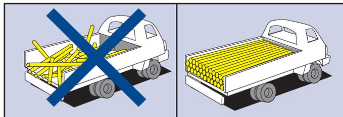
2. Los vehículos de transporte deberán estar en condiciones de asegurar el mantenimiento de la calidad de origen de los tubos y accesorios.
