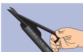
**1.** Deslizar la herramienta por el interior de la vaina para que quede enhebrada.
