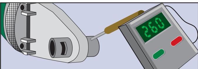
**7.** Mantener siempre el termofusor en óptimas condiciones de uso y constatar regularmente las temperaturas de trabajo de las boquillas con termómetros de contacto (pirómetro).
